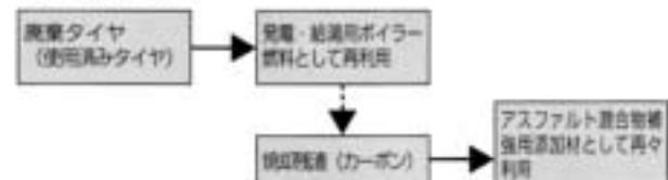
②廃タイヤカーボンをアスファルト混合物に添加することによって、アスファルト混合物の強度がアップする。特に真夏に起こる流動わだち掘れに対する抵抗性が増大することが室内試験より確認されている。
